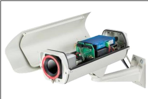
**Abbildung 28:** Outdoor-Schutzgehäuse für PI Kamera, USB-Server und industrielles PIF
