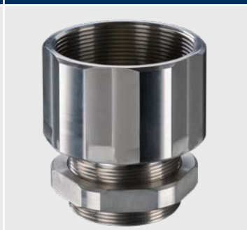
ACCTLA20UN Adaptateur de filetage M48x1,5 sur filetage 20 UN-2A incl. écrou de montage
